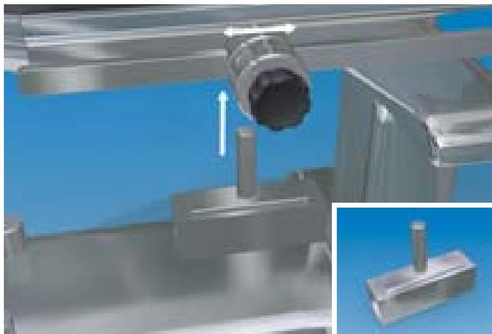
Installer le patient sur la table orthopédique. Glisser le système de fixation de Clark sur le rail latéral de la table orthopédique. Insérer le pivot vertical du Coulisseau de bas en haut dans le système de fixation de Clark et serrer l'étrier sur le pivot de manière à ce que le Coulisseau soit solidement fixé en place.
