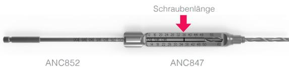
Beim Einbringen einer Ø6.5 mm Zugschraube (QT6.5LxxD), zur Bestimmung der geeigneten Schraubenlänge, die Skala des Ø3.0 mm Bohrers (ANC852) verwenden und die gewünschte Länge direkt an der Rückseite der Ø3.0 mm Bohrhülse (ANC855) ablesen.
