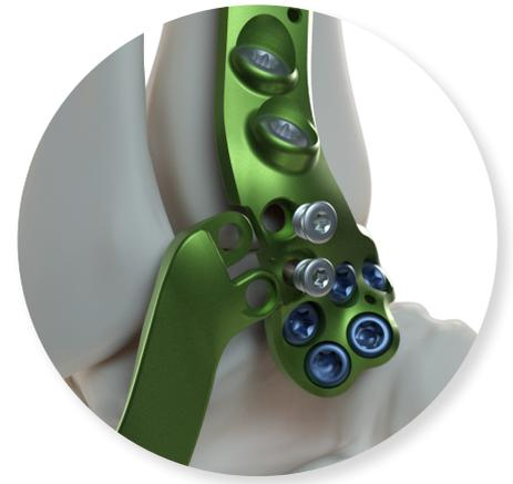
3. Den lateralen Zusatz auf der Platte befestigen und das Konstrukt mit den beiden Fixationsschrauben mithilfe des **Schraubendrehers T8 (ANC575)** und des **Handgriffs mit Schnellkupplung, Torque 1.0 N.m (TD111401 - 1N.m)** verriegeln.
